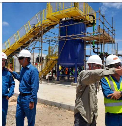
Foto 14 – Equipamentos em operação (tanque para mistura de areia/salmoura) no pátio de operação do preenchimento ("backfilling II").
