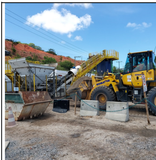
Foto 13 – Equipamentos em operação (pá carregadeira alimentando o tanque misturador com areia) da planta de preenchimento ("backfilling II").
